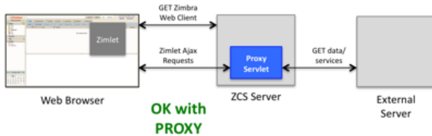
Schéma du proxy de Zimbra en fonctionnement sur un exemple simple
