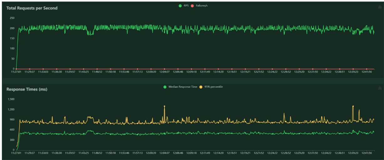
Exemple de visualisation Locust, en haut, le nombre de requêtes par secondes. En bas, temps de réponse moyen
