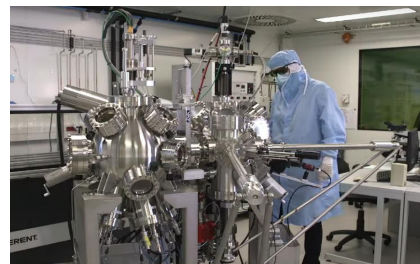
Dépôt du LSMO dans la salle blanche du GREYC
