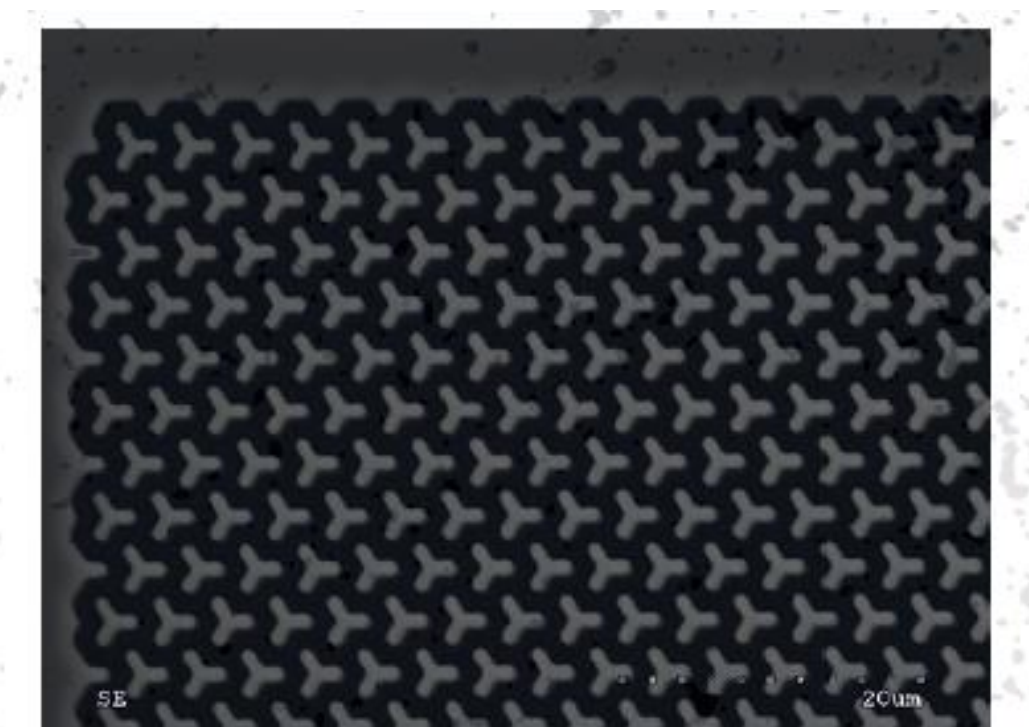
Vue de dessus des structures en tripod faites dans le Silicium, réalisée avec un MEB- 2019 – échelle : la largeur d'un tripod est de l'ordre de 2µm © Murata Manufacturing Co., Ltd
